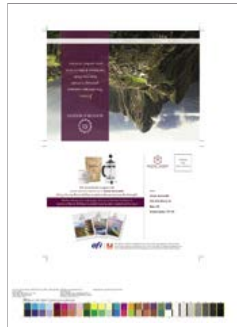
Farbkontrollstreifen auf jeder gedruckten Seite zur Qualitätskontrolle
